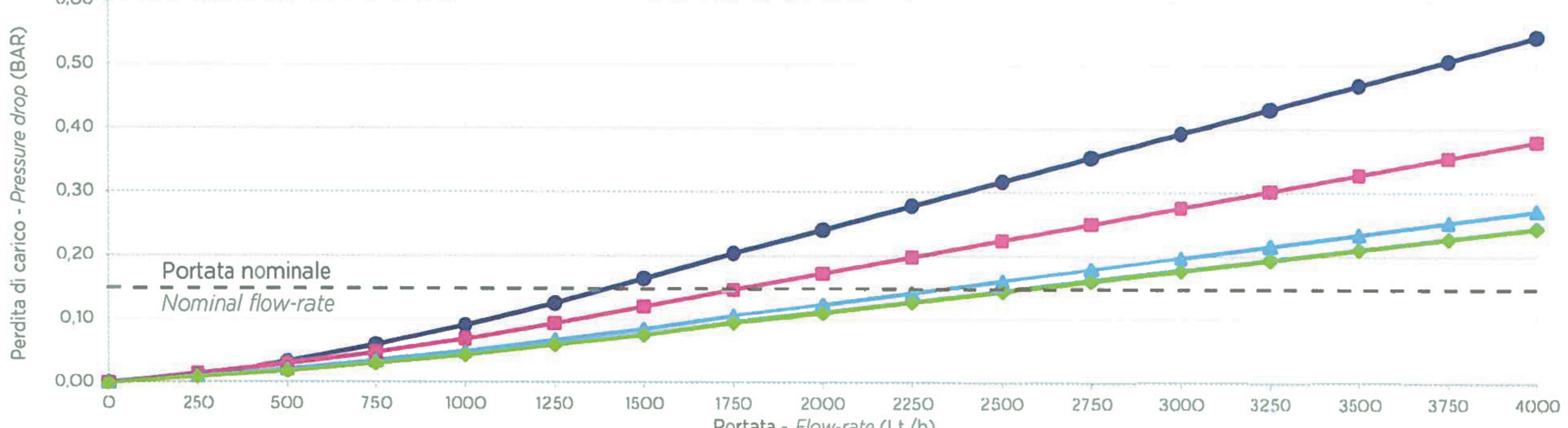
N.B.: Test effettuati su cartucce nuove in contenitori AQUA - Pressione ingresso 3 BAR - Temperatura acqua 20°C/Tests of new cartridges performed on AQUA housing for filter - Inlet pressure 3 BAR - Water temperature 20°C
